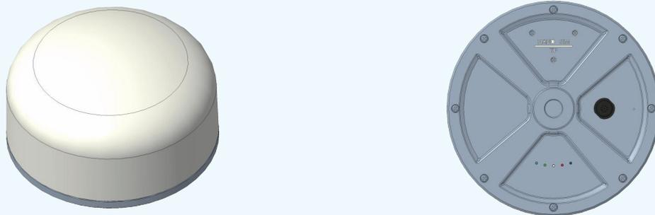
DM470变形监测一体机是一款北斗兼容GPS/GLONASS的三系统六频点高精度GNSS变形监测一体机,支持BDS B1/B2、GPS L1/L2和GLONASS L1/L2频点。可以为用户提供毫米级精度的变形监测信息,具备内置的GNSS/4G/WIFI天线以及一体化通讯接口,支持多种数据传输格式和64G大容量存储,适用于滑坡监测、桥梁监测、路基监测等形变监测应用领域。
